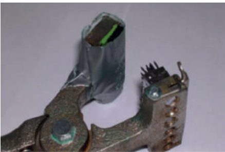
Figura 5: Espuma y cinta instaladas en la tatuadora
